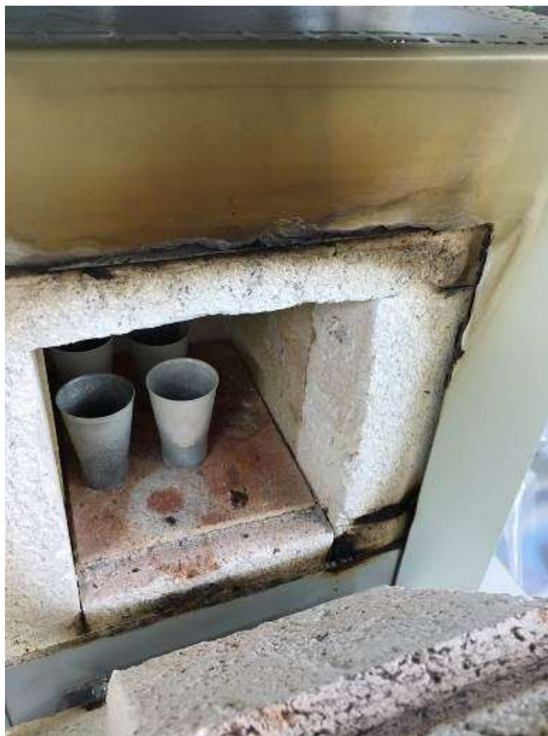
Рис.5. Сухое озоление проб в муфельной печи.
