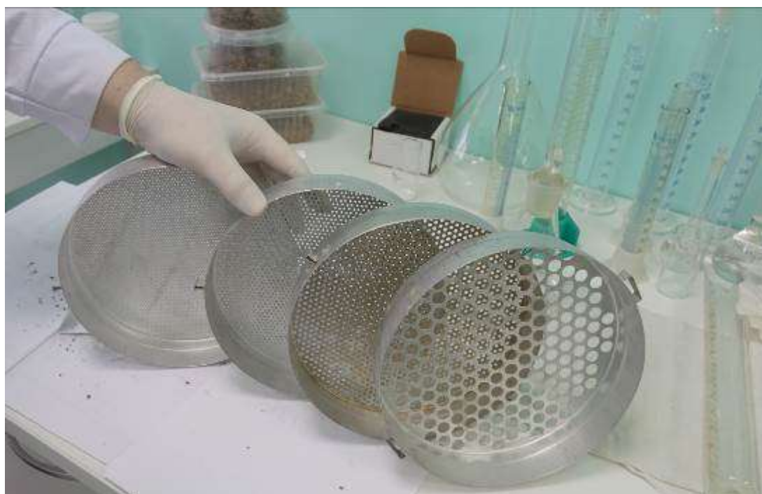
Рис.4. Набор сит для просева образцов почвы.
